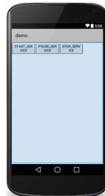
Slika6- LinearLayout sa horizontalnim rasporedom
