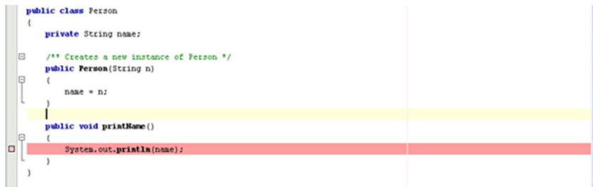
Slika-1 Postavljanje tačke zaustavljanja
