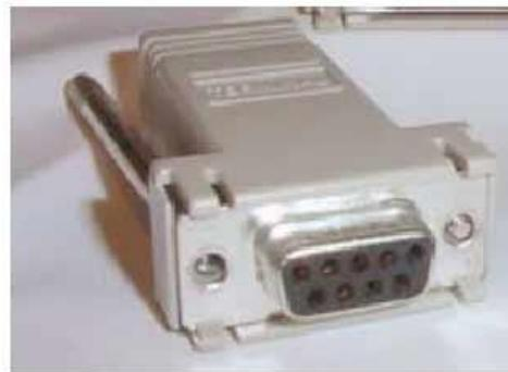
Rollover kabl služi za spajanje AUX porta i modema preko RJ45/DB9 adaptera. Nakon uspešne konekcije na ruter, pomoću programa (npr Hyper Terminal) vrše se potrebna podešavanja za pristup Command Line Interface-u radi pisanja naredbi.
