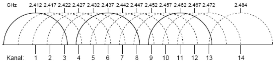
Na slici iznad, prikazana je grafički frekventna raspodela kanala.
